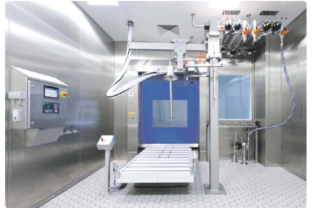
Reinraumklasse GMP D zur Abfüllung von flüssigen Arzneimittelvorstufen.
